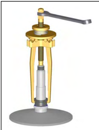
Retrait de la bague de serrage (1b)
