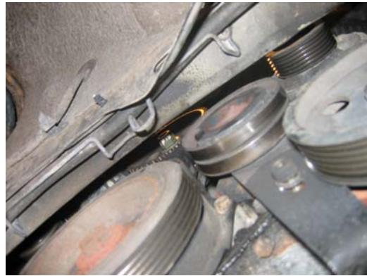
Courroie d'alternateur détendue et déposée.
