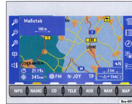
Fig. 40 Modification de l'échelle
